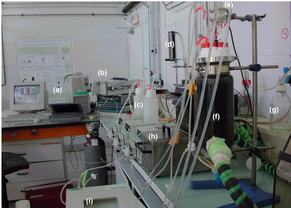
**Figure 4 :** Photo de la chaîne de fermentation. (a) gestion informatisée, (b) chromatographie phase gazeuse, (c) réservoirs d'acide et de base, (d) débit-mètre à bille, (e) condenseur, (f) cuve, (g) bullage du gaz en sortie de cuve, (h) bain-marie chaud associé à la cuve, (i) pompe péristaltique (les bidons de milieux frais et de soutirage de culture n'apparaissent pas sur cette photo).
