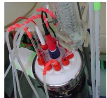
**Figure 5 :** Platine en Téflon percée de 11 entrées.
