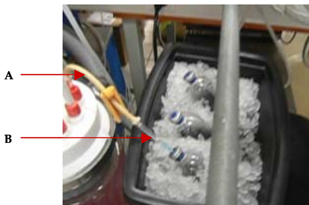
Figure 20 : Rampe anaérobie de prélèvement d'échantillons installée sur le bioréacteur. A, raccord en tuyau étanche au gaz Tygon silicone (Masterflex, Norton). B, embout de seringue.
