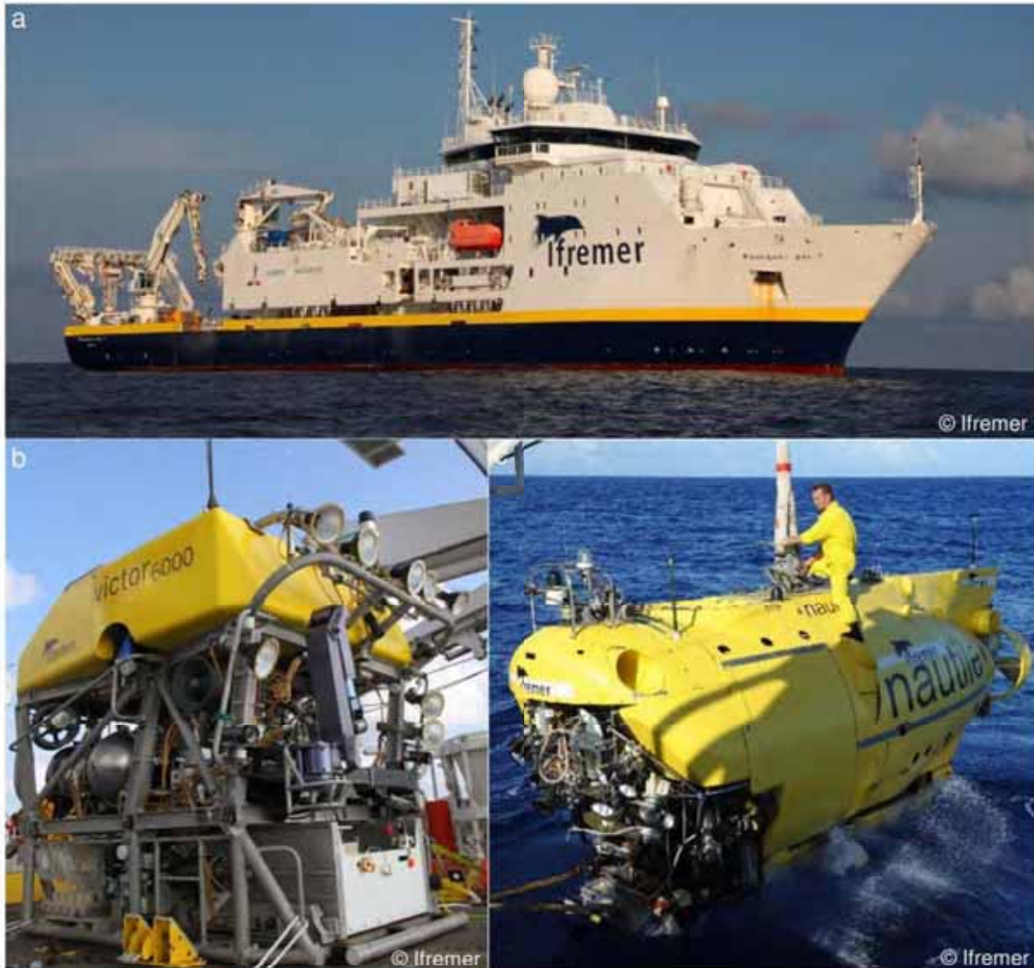
Figure 29 : photos en (a) du navire océanographique Pourquoi pas ? , en (b) du submersible non habité Victor 6000 et en (c) du submersible habité Nautilus .
