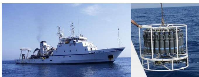
Figure 45: A gauche le navire de recherche Italien URANIA, à droite le carrousel avec les 24 bouteilles NISKIN et la sonde CTD située dans la partie basse.
