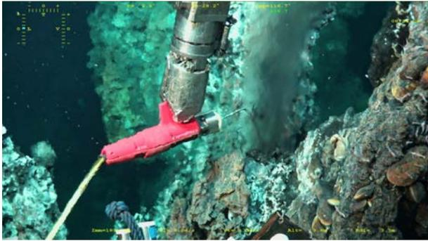
Mesurer, prélever, analyser c'est aussi ce que font nos collègues géochimistes, Emmanuel Reinert et Cécile Cathalot de l'Ifremer, pour caractériser le fluide hydrothermal qui sort des cheminées. Le **thermomètre**, délicatement introduit dans le conduit de la cheminée, indique une température de 296°C. Mais à 190 bars de
